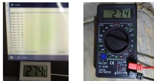
Gambar 19. Pengujian Sensor Pada Suhu 27,4 °C
